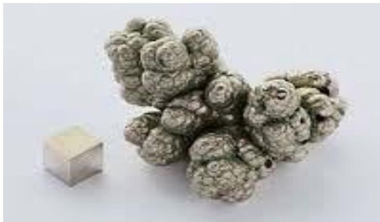
En aleaciones el níquel aporta dureza, tenacidad y menor peso, así como buenas características, anticorrosivas y conducción eléctrica y térmica.
