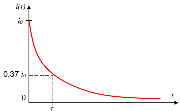
valor hasta el 37% del mismo, aproximadamente. En el instante  $t = 5\tau$  el valor de  $i(t)$  representa el 0,00001% del valor inicial y suele considerarse que, a partir de entonces, el capacitor está descargado. La representación de  $Q(t)$  en función del tiempo tiene una forma similar (con el debido cambio de las magnitudes de los ejes y sus escalas) y similares características.
