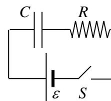
Al comenzar a circular la corriente de carga del capacitor se produce una tensión entre sus placas y otra entre los extremos de la resistencia. La intensidad de la corriente en un instante genérico  $t > 0$  es  $i(t)$  mientras que el valor instantáneo de la carga del capacitor es  $q$ . Si se aplica la segunda regla de Kirchhoff a la malla, para ese instante, se tiene:
