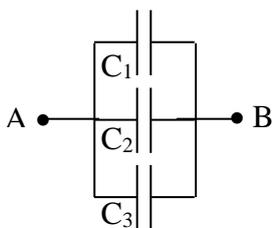
Dos o más capacitores están conectados en paralelo entre los puntos A y B cuando cada uno de ellos tiene una placa conectada al punto A y la otra al punto B.
