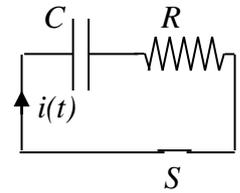
El signo negativo que precede a la derivada de la carga con respecto al tiempo se debe a que la carga  $q$  del capacitor disminuye con el tiempo y esto hace que sea  $dq < 0$ .
