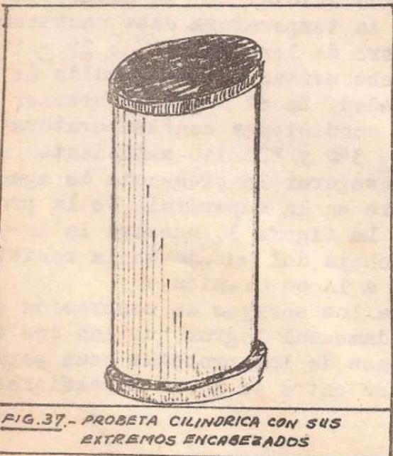
FIG.37.- PROBETA CILINDRICA CON SUS EXTREMOS ENCABEZADOS
