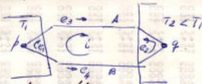
La aparición de la corriente en el circuito cerrado, es causada por la superposición de dos efectos termoeléctricos:
