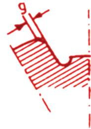
La carga no se reparte equitativamente entre las ranuras y los rebordes, de modo que hay que aplicar un factor de ajuste  $f$ :
