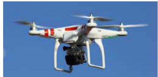
Según el número de rotores que tenga el dron se lo puede clasificar en tricópteros (3 motores), cuadricópteros (4 motores), hexacópteros (6 motores) y octacópteros (8 motores).
